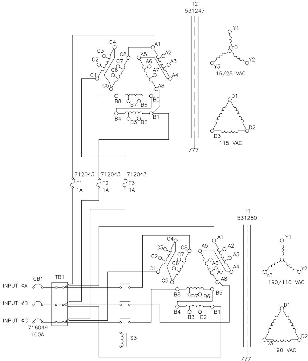
**FIGURE 3.3.1 480 V INPUT CONFIGURATION**
