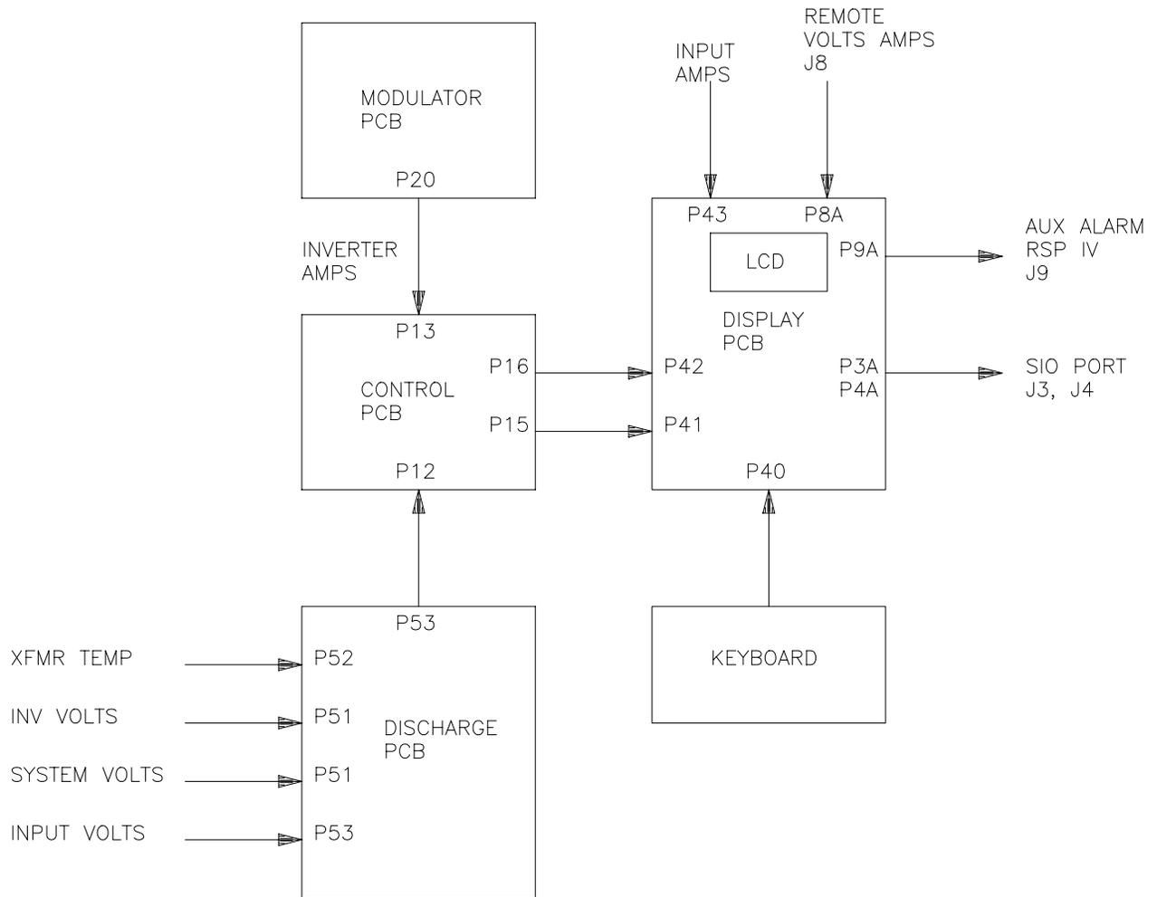
**FIGURE 6.2.5 BLOCK DIAGRAM DISPLAY CIRCUITS**
