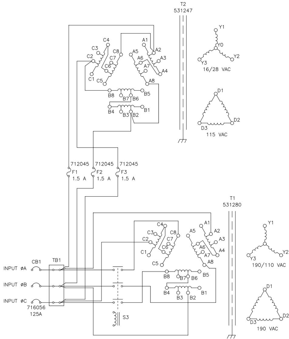
FIGURE 3.3.2 380 V INPUT CONFIGURATION
