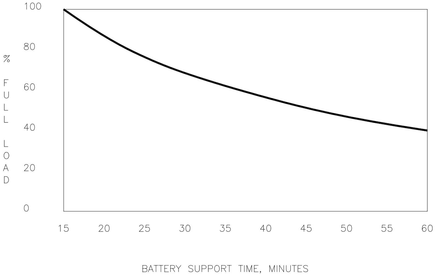
**FIGURE 2.1.2 BATTERY SUPPORT TIME**
