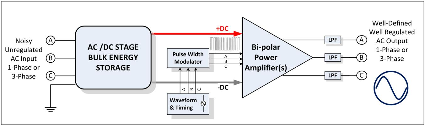
Fig. 3. AC-to-AC Switch-Mode Power Conversion
